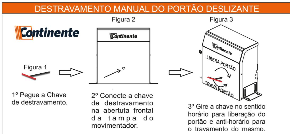
Figura 06: Procedimentos para destravamento manual do Movimentador Deslizante.
