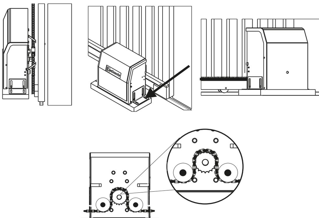
**Figura 03:** Transpassar a corrente conforme imagem e fixar no portão, com um ponto de solda, observando que a engrenagem se encaixe na corrente, para que ocorra a movimentação do portão no momento que o movimentador for acionado.
